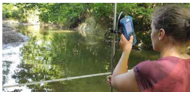
Mesure de débit dans une rivière
